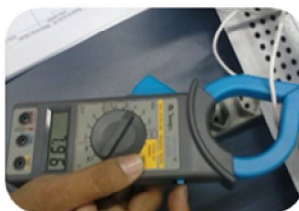
Uso do alicate amperímetro.
